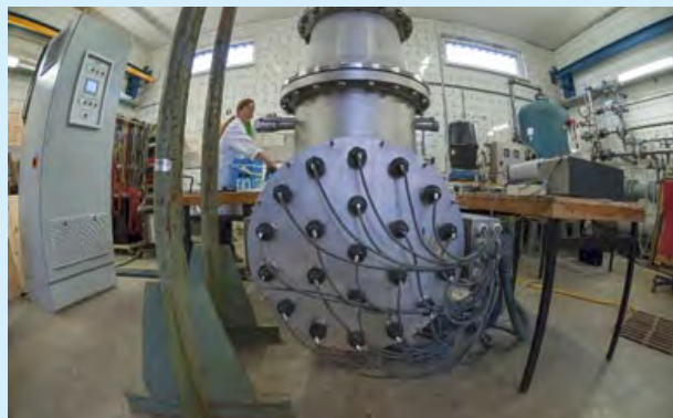
Validierung eines UV-Gerätes zur Desinfektion von Trinkwasser am Prüfstand des Wasser-Technikums Wiental
